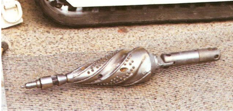
Fig. 5.10 Perforación dirigida. Ensanchador
